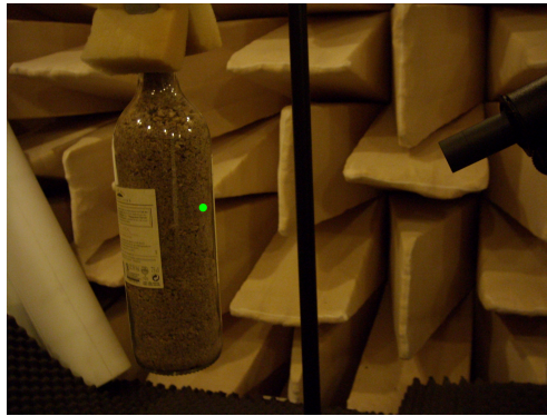
Figure 2.4 – exemple d'un objet initialement 3dc qui a été rempli avec du sable pour correspondre à un objet 3dp (ver_s30_3dp_cen.JPG)
